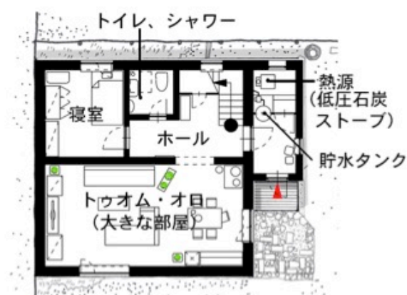
図6-15：住まいに対する積極的な工夫の見られる事例 極めてまれなケースだが、住宅建設の知識のある住民が、「靴脱ぎ」の場所を設け、ストーブを居住空間の外部に設置し、トイレも住居内部に実現して、清潔で暮らしやすい住居を実現している。
