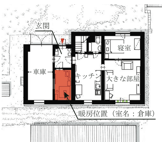
図3：温水循環式暖房の位置 no.11_14 より
