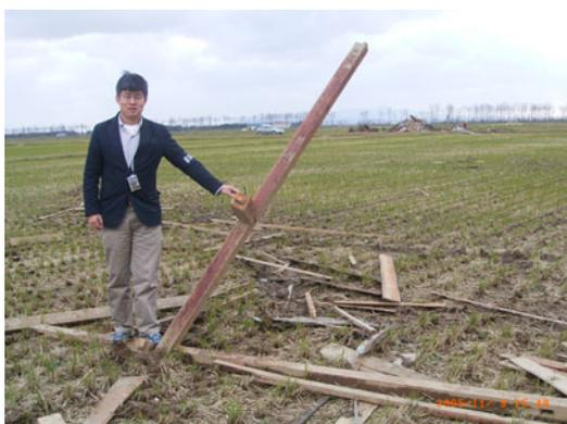
地点3と4の間に飛散した建物の骨組が突き刺さっている。人力では抜けなかった。
