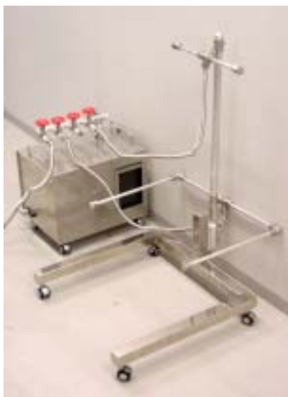
(1) 空気清浄装置本体&清浄空気供給ユニット
