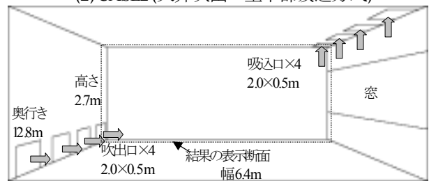
(3) CASE3 (壁下部吹出・天井吸込方式)
